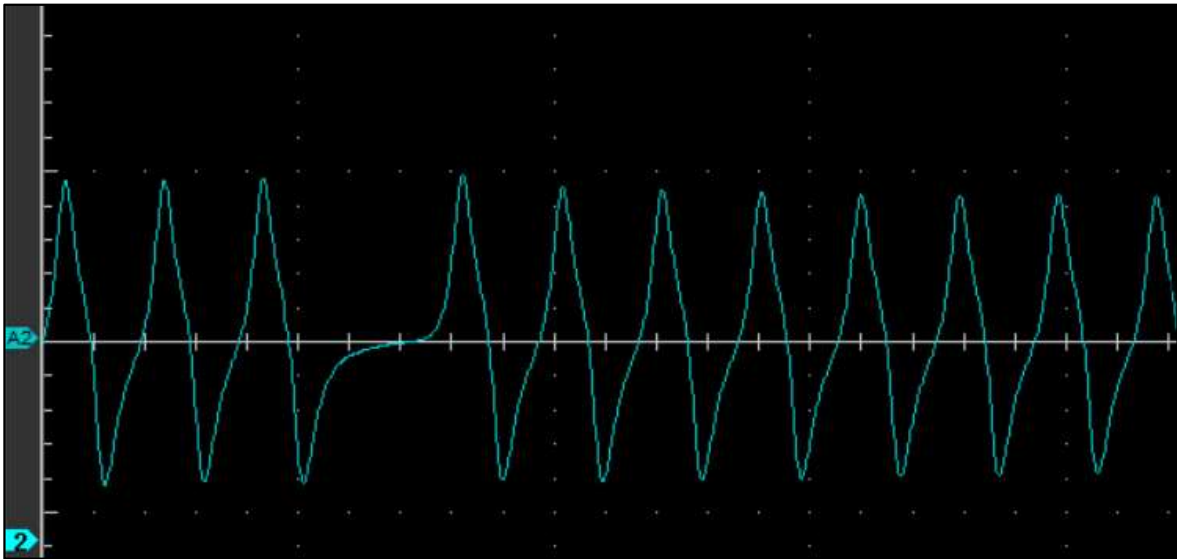
Figura 1: Grafica de honda de trabajo del sensor CKP, rango de trabajo 5000ms, 2 voltio por cuadro.
